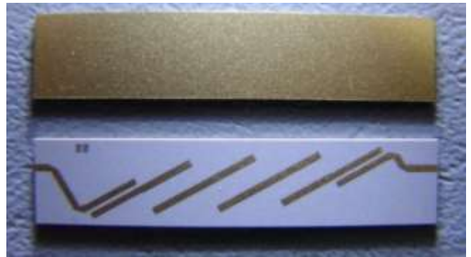
Microstrip line filter (Substrate: D-9)
